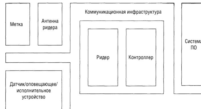
Рисунок 1 – Общая схема RFID-системы
